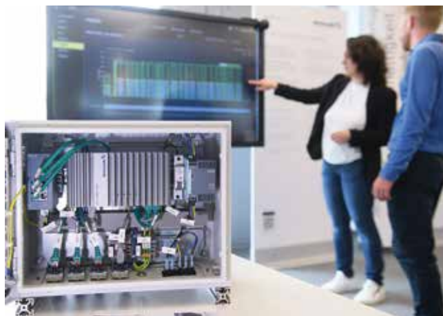
Edge v krabici: Všetok hardvér systému je zostavený v rozvádzači, ktorý môže používateľ jednoducho nainštalovať a potom ho spoločnosť Schuler aktivuje na diaľku.
