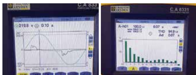
Obr. 2 Priebeh napätia a odoberaného prúdu žiarivkou Livarno Lux 13 W (vľavo), FFT odoberaného priebehu prúdu, zaznamenaný sieťovým analyzátorom Chauvin Arnoux C.A 8331 (vpravo)
