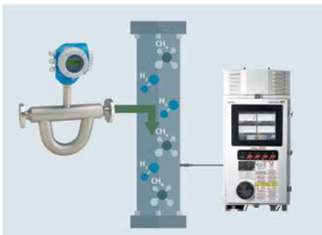
Procesný analyzátor Endress+Hauser Raman Rxn5 overuje zmes plynov, upravuje kontrolu dopovania riadenú Coriolisovým meračom a zabraňuje prekročeniu úrovne vodíka.
